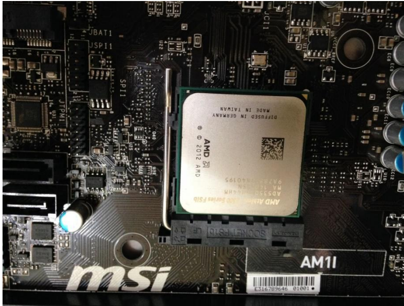
วาง CPU ให้ขา 1 ตรงกันแล้วปิด ขายึด Socket ตามเดิม
