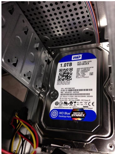
หงายด้านที่มี Label ขึ้น แล้วใส่เข้าไปในช่อง
