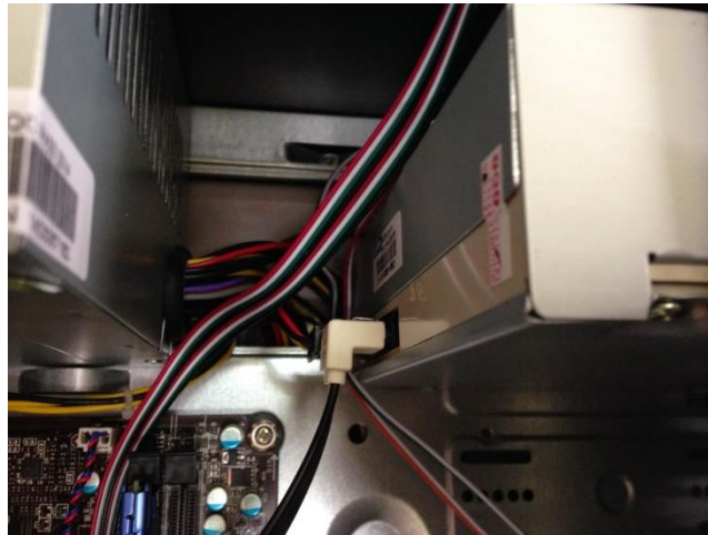
นำสายไฟและสายส่งข้อมูลมาต่อเข้ากับ HDD และ ODD ให้เรียบร้อย
