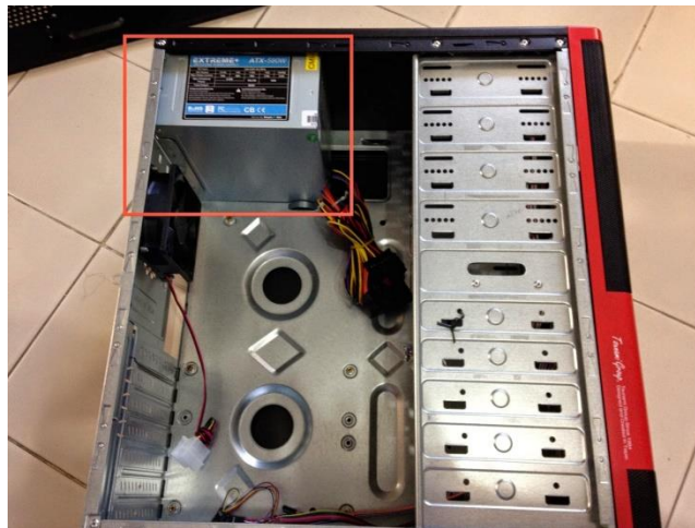
ตำแหน่งที่วาง PSU ในเคสแต่ละรุ่นอาจแตกต่างกัน
