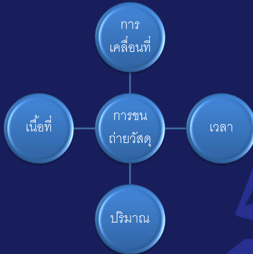
รูปที่ 1 การขนถ่ายวัสดุกับองค์ประกอบที่สำคัญ
